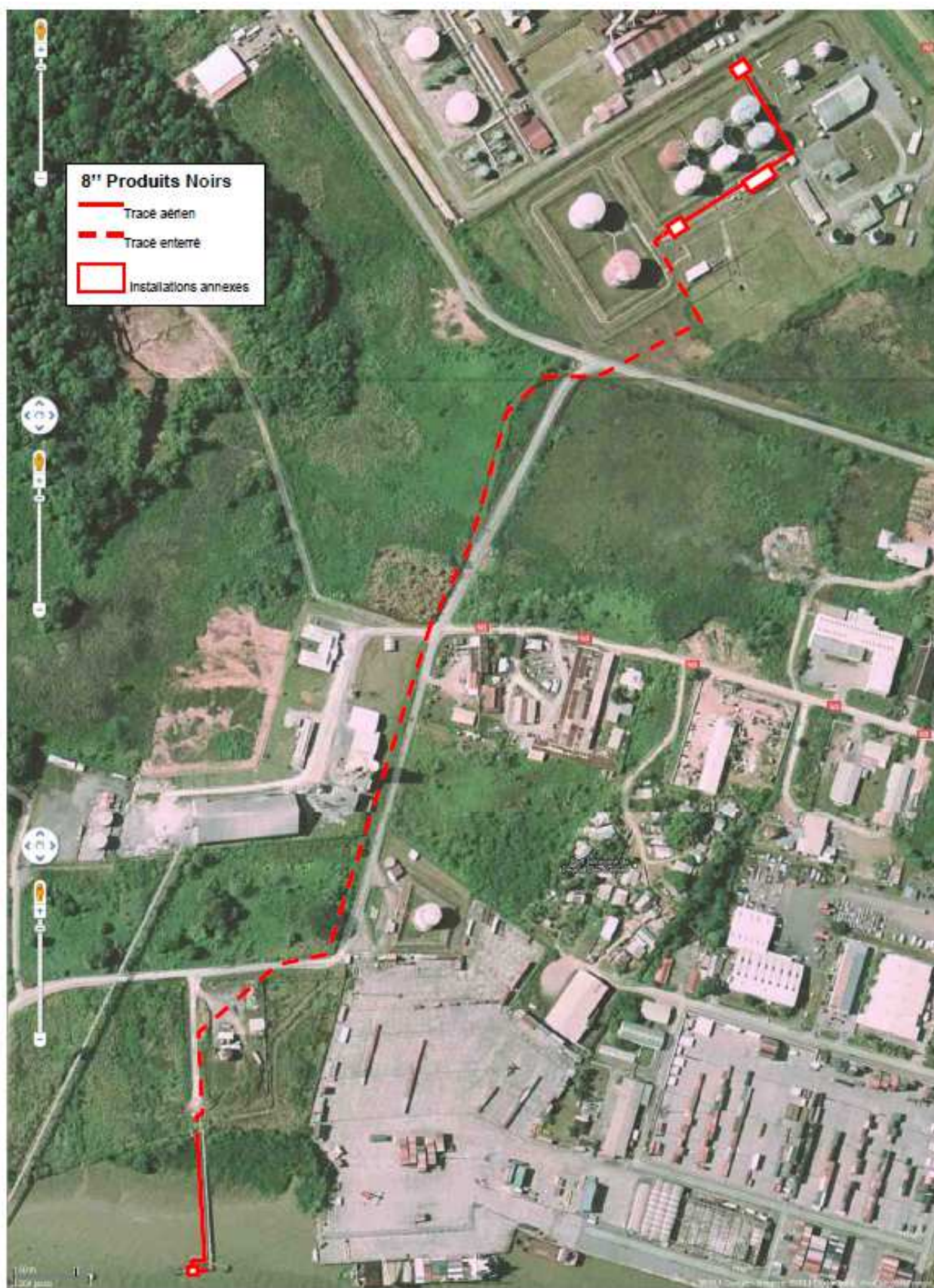
Figure 16 : Tracé des canalisations reliant l'apportement à la SARA
